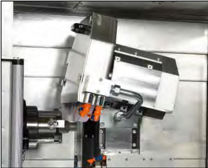
Außenschleifen mit leistungsstarker Schleifspindel im Schrägeinstich, auch zum Planschleifen von Schultern.
