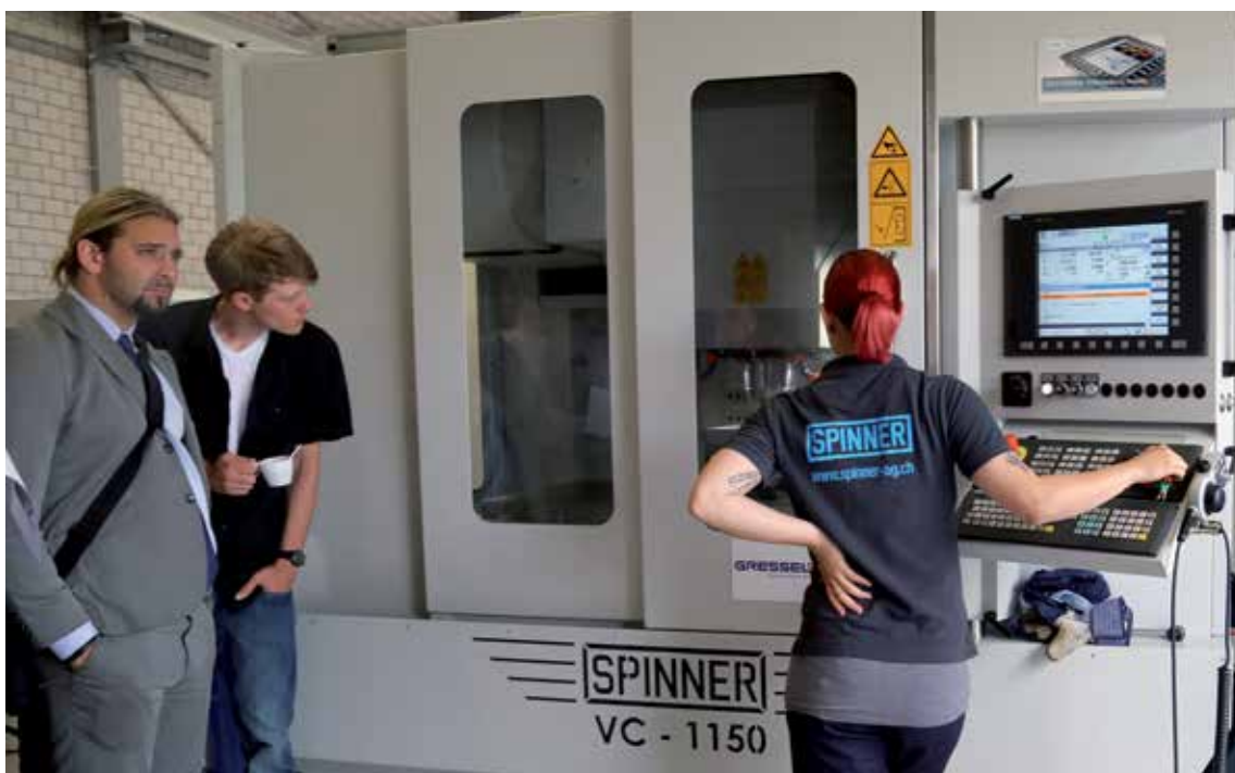
Auf dem neuen Hochleistungsbearbeitungszentrum VC 1150 demonstrierte Spinner auf der Hausausstellung seinen Kunden verschiedene Bearbeitungsvarianten der Maschine für die Fräsbearbeitung.
